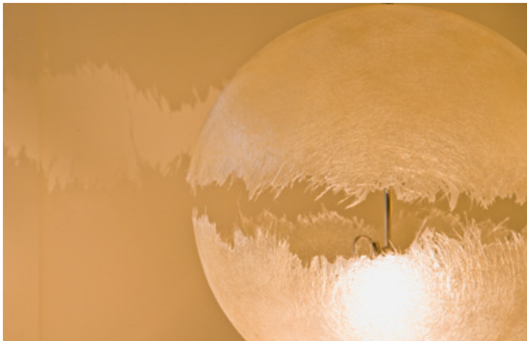
Glassfiber blir brukt til å diffusere og reflektere diodelyset.
